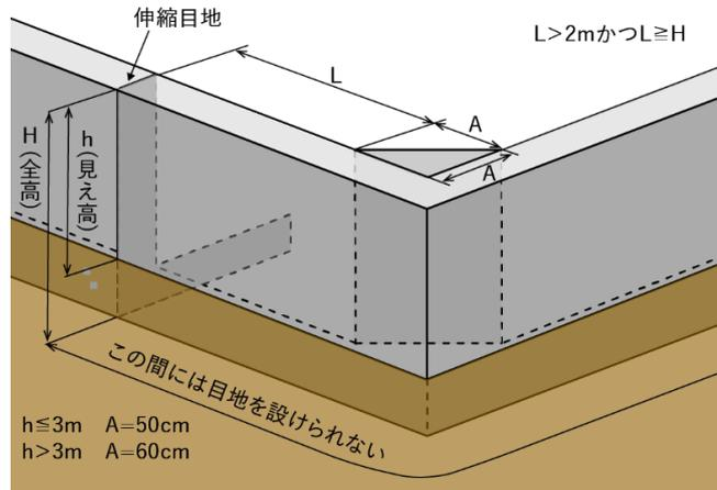
図 2-23 鉄筋コンクリート造擁壁等の伸縮目地及び隅角部の補強位置①
