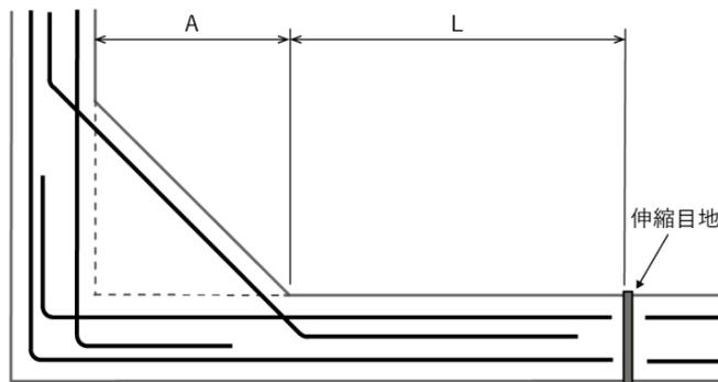
図 2-24 鉄筋コンクリート造擁壁等の伸縮目地及び隅角部の補強位置②
