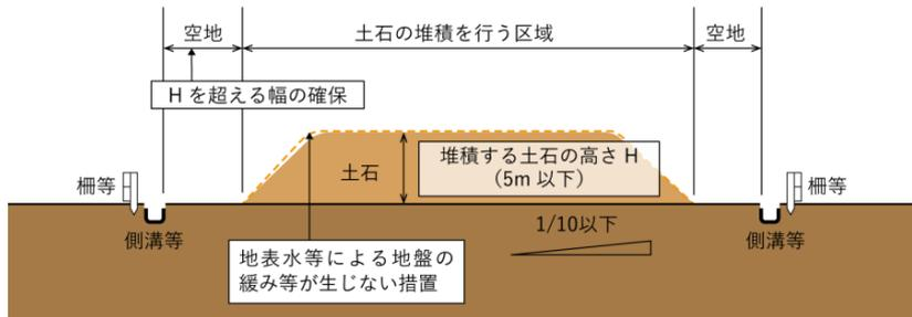
図 2-57 堆積する土地の基準 (高さ 5m 以下)
