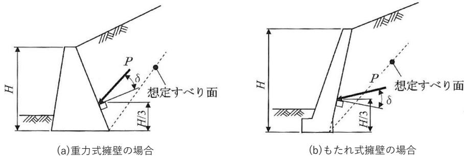
図 2-30 土圧作用面（重力式擁壁等）
