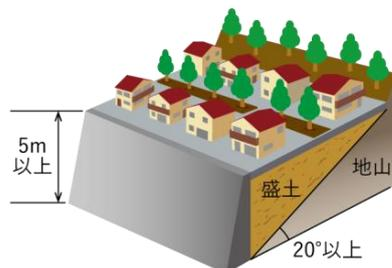
図 2-8 腹付け型大規模盛土造成地のイメージ
