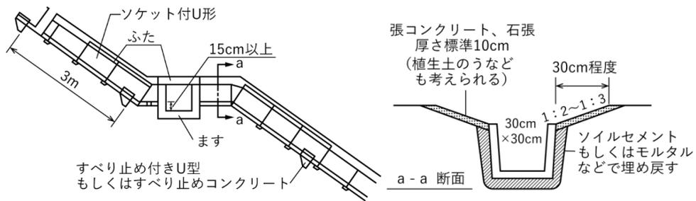
図 2-54 U型による縦排水工の構造図
