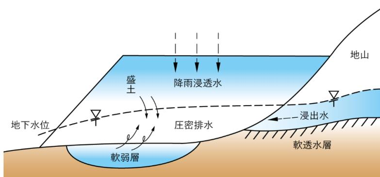
図 2-55 地下水の各構成成分
