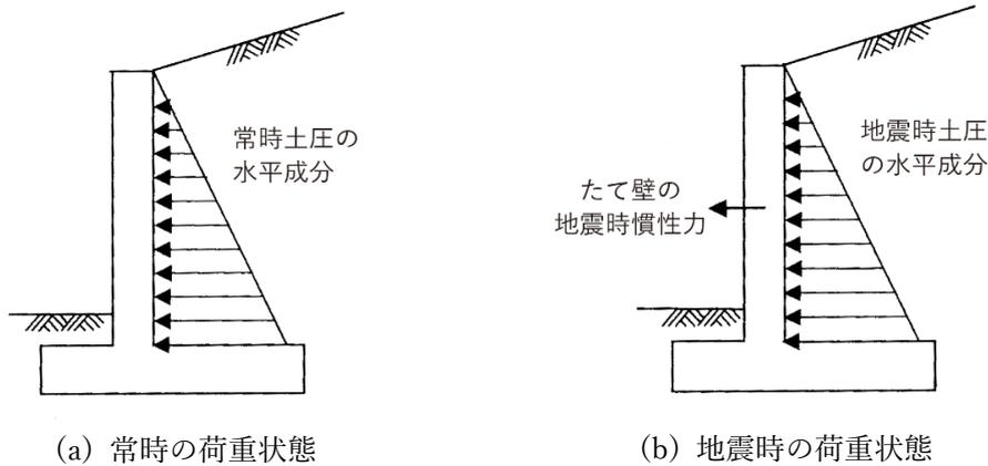
図 2-40 豎壁の断面計算における荷重状態
