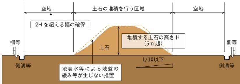
図 2-58 堆積する土地の基準 (高さ 5m 超)
