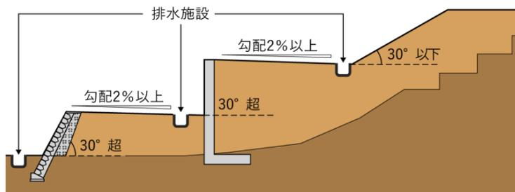
図 2-4 崖面の排水例
