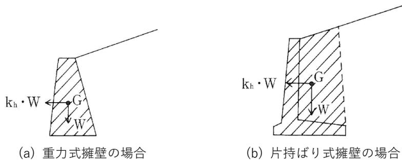
図 2-36 地震時慣性力の考え方
