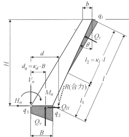
図 2-39 地盤反力係数法 (簡便法)
