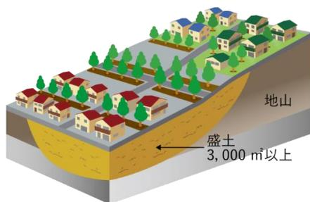
図 2-7 谷埋め型大規模盛土造成地のイメージ
