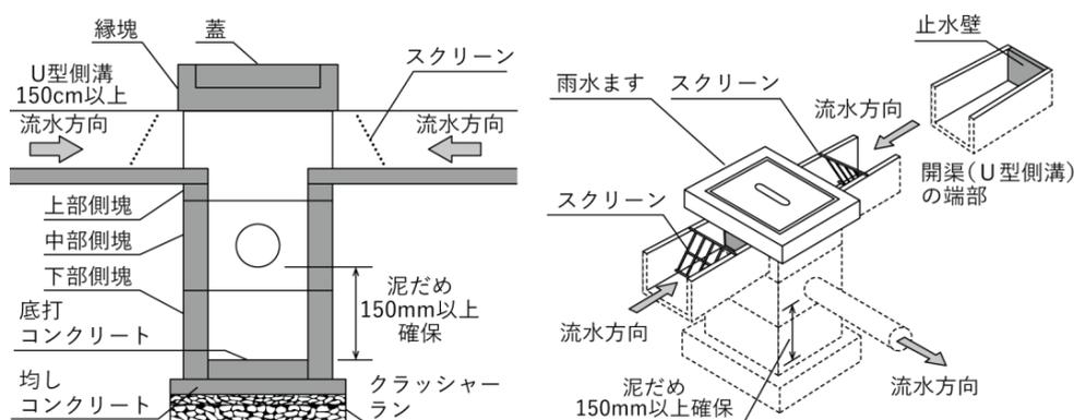
図 2-49 排水工の標準構造図
