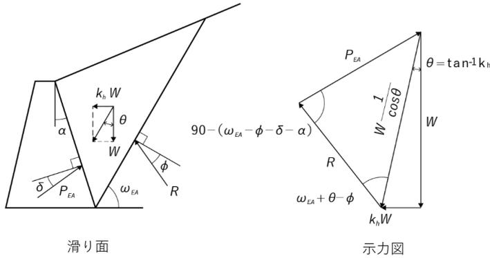
図 2-34 地震時主働土圧の考え方
