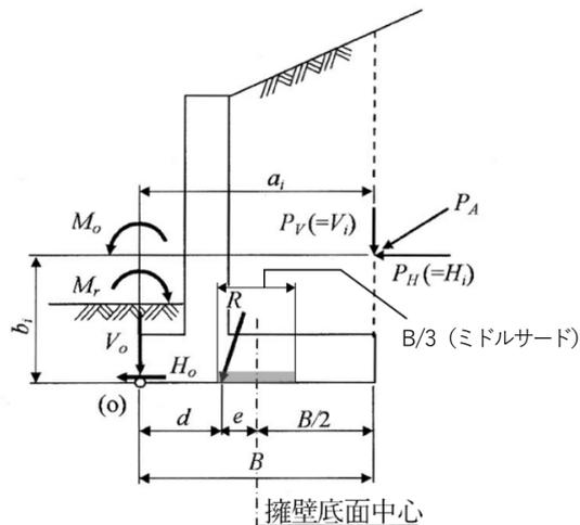
図 2-37 合力作用位置の求め方
