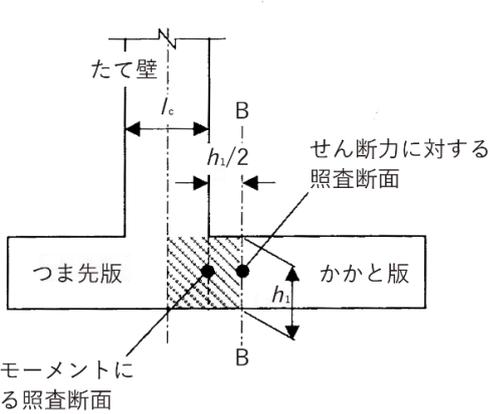
図 2-44 かかと版のせん断力を照査する断面
