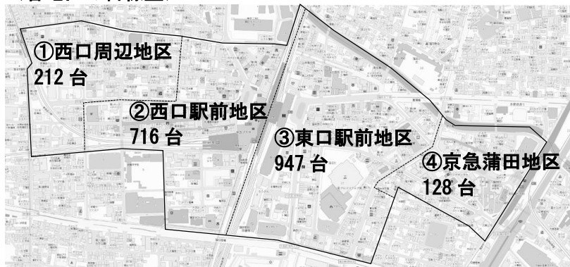
図 乗用車の駐車施設確保の目標量
