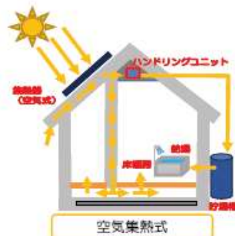
軒先から取入れた外気を、屋根等の集熱器（パネル）で暖めて暖房などに利用します。
