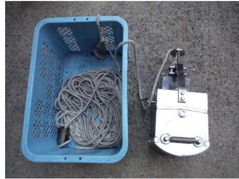
図3 エクマンバージ採泥器
