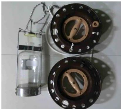
図 2 ハイロート型採水器
