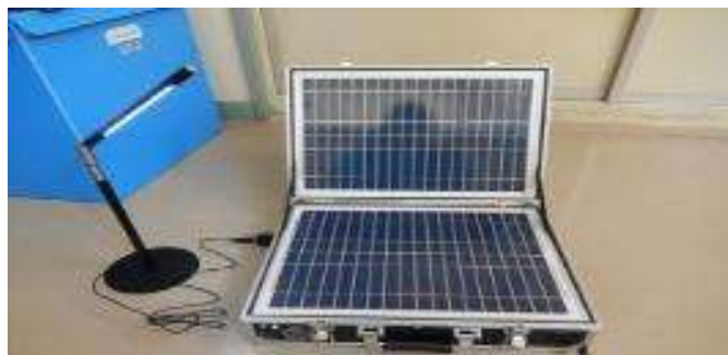
ソーラー式蓄電池
