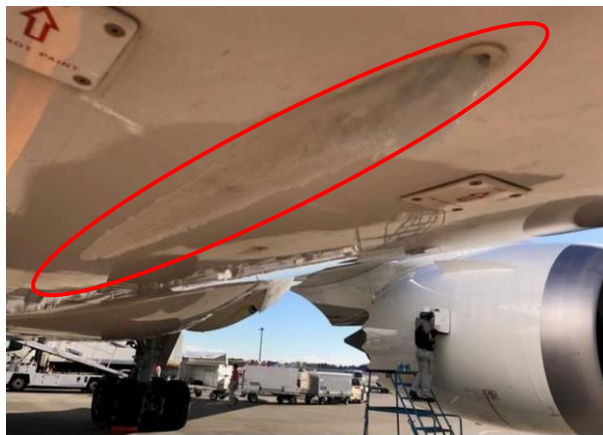
図 3-3 胴体ドレインへの着氷事例
