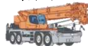
ラフタークレーン
