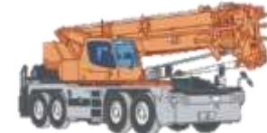
ラフタークレーン
