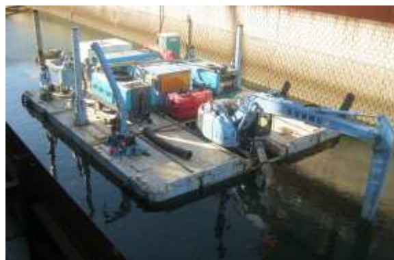
写真 2.5 高濃度式ポンプ浚渫船
