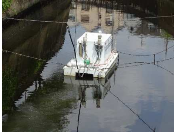
写真 2.3 スカム発生抑制装置
