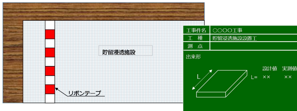
図 4-1 貯留浸透施設の撮影例
