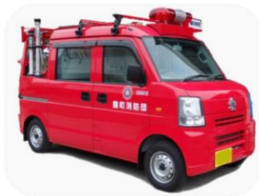
可搬ポンプ積載車
