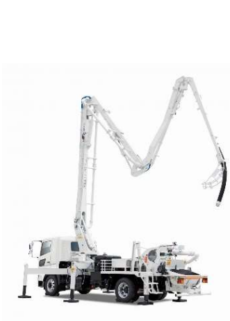
コンクリートポンプ車
