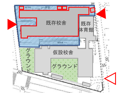
STEP3：既存校舎解体 既存体育館改修
