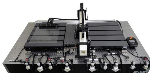
第27回新製品・新技術コンクール 最優秀賞 非接触吸着盤「ノンコンタクトチャッキング」 液晶業界向け非接触吸着盤
