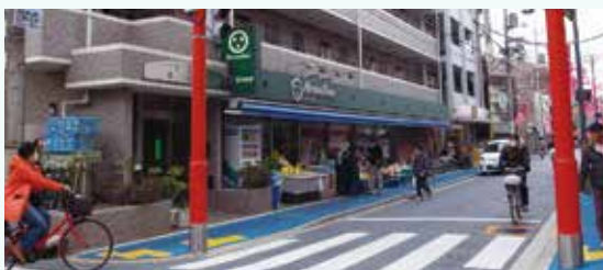
○集合住宅の入口部分を商店街の連続性を断ち切らない大きさに抑えています。(東雪谷 C1, C5)
