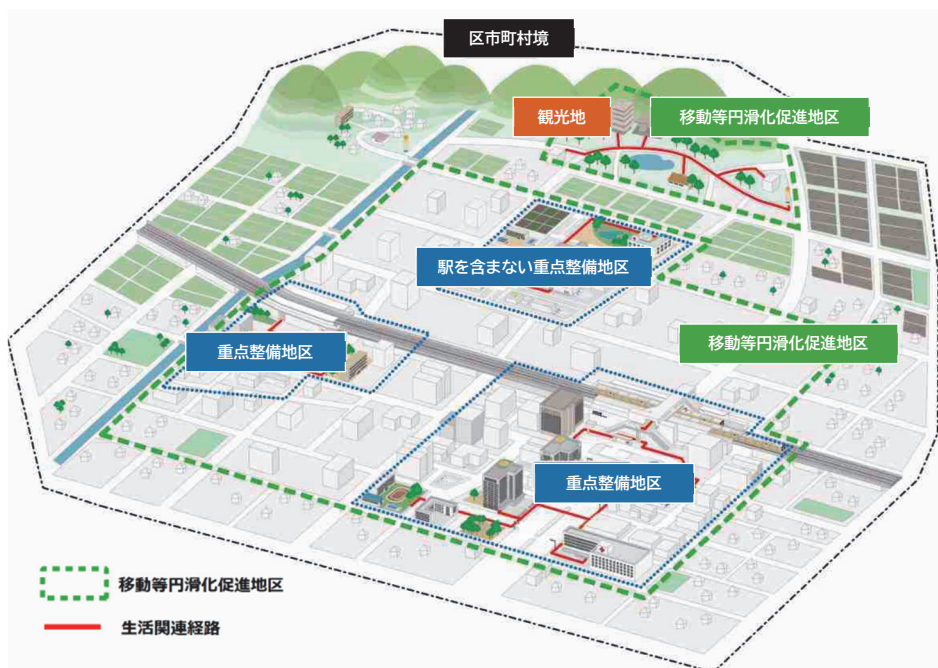
図 1-3 移動等円滑化促進地区と重点整備地区の配置関係のイメージ
