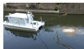
スカム発生抑制装置全景
