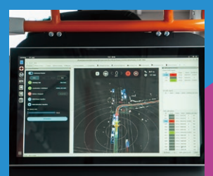
▲半径120mを検知したものを表すモニター
