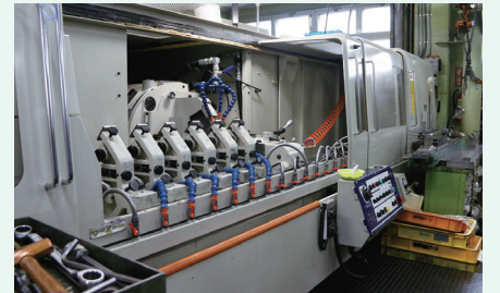
ボールねじを研削する機械
