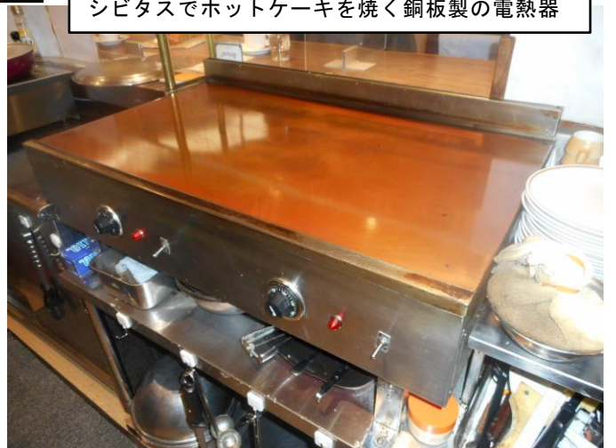
シビタスでホットケーキを焼く銅板製の電熱器
