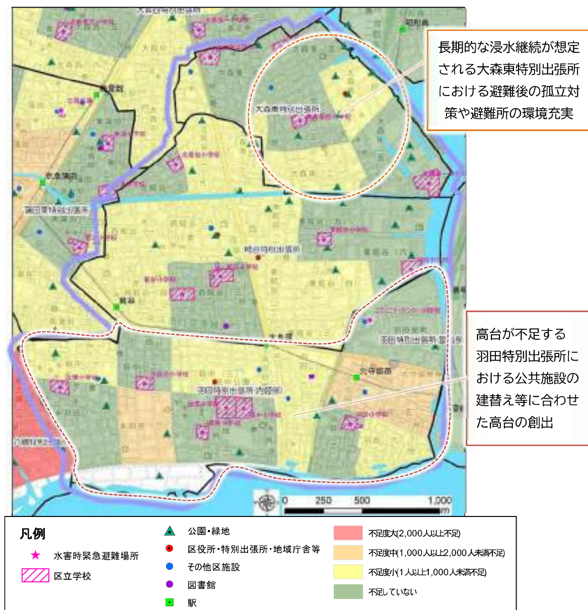
図 33 糀谷・羽田地域の水害リスク分析結果と高台まちづくりの方向性
