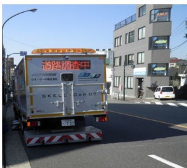
空洞探査車両による調査
