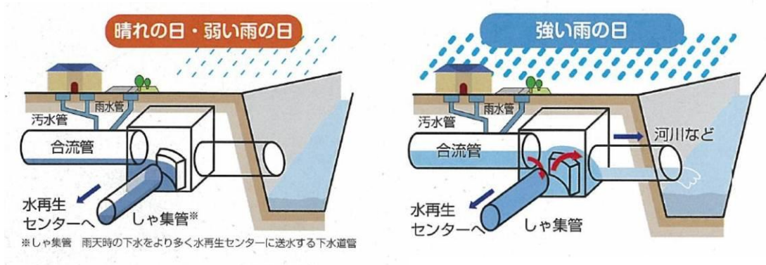
図 3.2 合流式下水道の概要図
