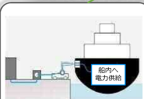
船舶への陸上電力供給設備
