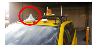
滑走路に進入する車両に位置情報等送信機を搭載
